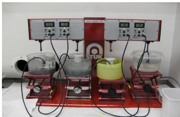
Figure. 20. Electrodeposition apparatus.
