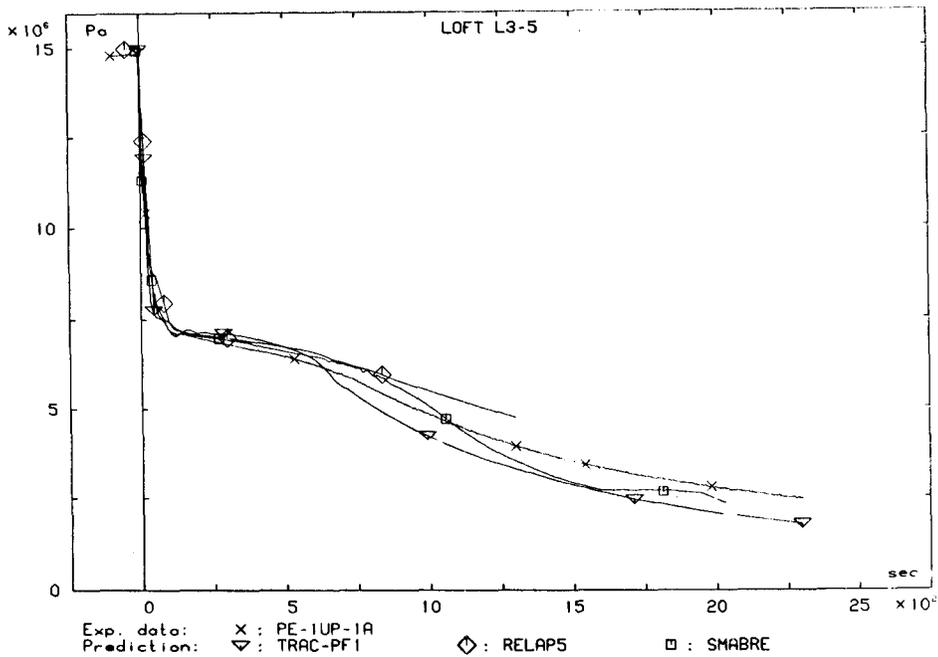
Fig. 3.1.4.1 Pressure in upper plenum
